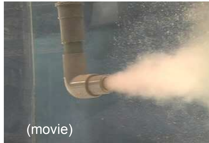
use of a low pressure (~3atg) pump (Aura Tec Co. Ltd.)
